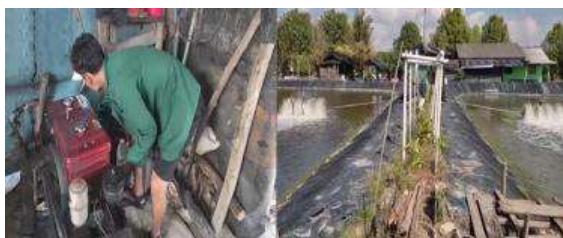
Gambar 2. Mesin diesel 8 PK berbahan bakar solar penggerak 2 unit kincir air
