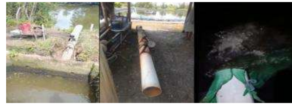
Gambar 3. Mesin pompa air alkon berbasis engine 5,5 HP memakai bakar solar
